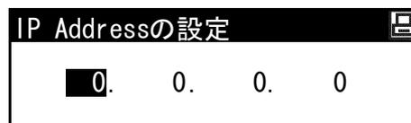
7 [>] キーを押してください。反転表示されている次の 3 桁のアドレスを入力してください。
