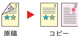
両面原稿を1ページずつ片面コピーします。原稿送り装置に原稿をセットしてください。
