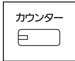
カウンターキーを押すと、印刷枚数および読み込み枚数を参照することができます。
