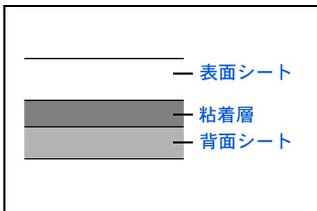
ラベル紙は、図のような3層からなる構造をしています。粘着層は本機内部で加わる力による影響を受けやすい素材でできています。背面シートはラベルが使用されるまで表面シートを保持しています。このように構造が複雑なため、ラベル紙はトラブルが発生しがちです。
