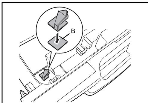
ストッパ（A）を使用しないときは、同梱のマジックテープ（B）をカセットの中などに貼り付けて、収納してください。
