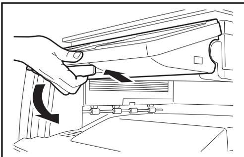
操作パネル下のレバーを引くと、角度を 2 段階に調節できます。
