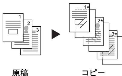
原稿を OHP フィルムにコピーした後、白紙の合紙を排紙します。( \* は OHP フィルムを示します。)
