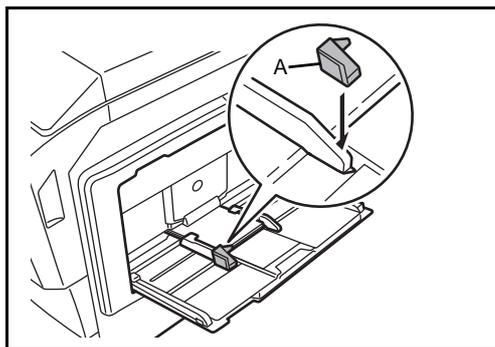
はがきを手差しにセットするときは、手前側のスライダにはがき専用のストッパ（A）を取り付けてください。
