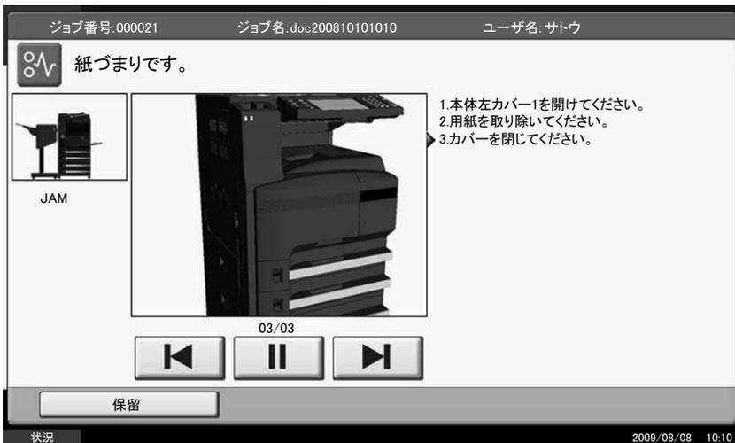
紙づまりが発生すると、タッチパネルに紙づまり位置表示と処置方法が表示されます。紙づまり位置表示は、下図のように紙づまりが発生している位置を表します。
