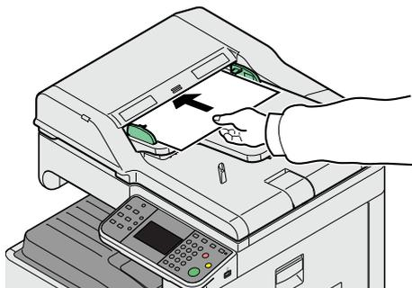
原稿幅ガイドに合わせて、原稿を上向きにセットします。
