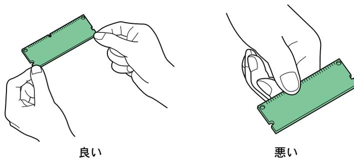
衣類やカーペットなどを通して人体に蓄積される静電気は、半導体チップを数多く搭載したメモリーには大敵です。静電気による破壊からメモリーを保護するために、装着前に水道の蛇口や金属製のものに触って人体の静電気を除去してください。できれば、静電気対策用のリストバンドを手首にお付けください。
