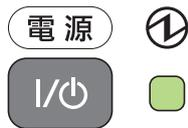
**電源**キーを押すと、主電源ランプだけが点灯し、タッチパネルや他のランプは消灯して消費電力を最小に抑えます。この状態をスリープと呼びます。
