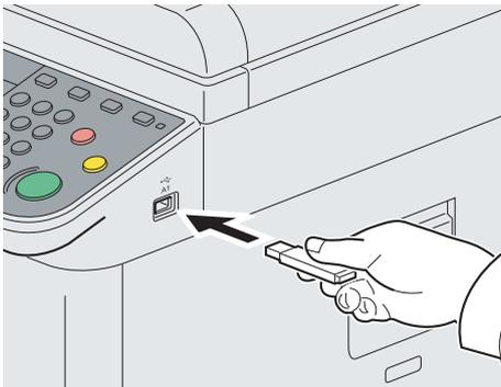
USBメモリーを使用する場合は、USBメモリースロット(A1)に挿入します。
