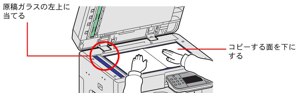
原稿送り装置または原稿押さえを開けて原稿をセットします。
