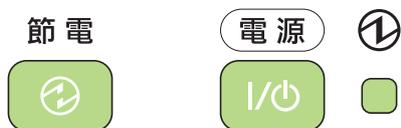
節電キーを押すと、節電キーのランプと電源キーのランプ、主電源ランプが点灯し、タッチパネルや他のランプは消灯して消費電力を低減します。この状態を低電力モードと呼びます。
