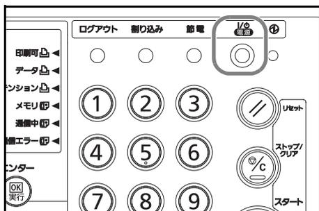
[電源]キーを押すと、主電源ランプだけが点灯し、操作パネルや他のランプは消灯して消費電力を最小に抑えます。この状態をスリープと呼びます。
