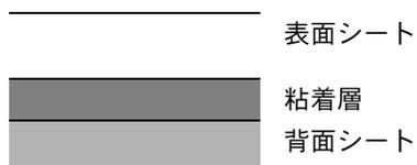
ラベル紙は、図のような3層からなる構造をしています。粘着層は本機内部で加わる力による影響を受けやすい素材でできています。背面シートはラベルが使用されるまで表面シートを保持しています。このように構造が複雑なため、ラベル紙はトラブルが発生しがちです。
