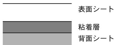
ラベル紙は、図のような3層からなる構造をしています。粘着層は本機内部で加わる力による影響を受けやすい素材でできています。背面シートはラベルが使用されるまで表面シートを保持しています。このように構造が複雑なため、ラベル紙はトラブルが発生しがちです。
