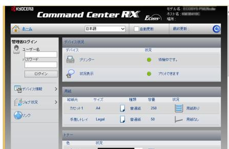
パソコンからリモートで、本機にアクセスし、データの印刷、送信、ダウンロードなどの操作ができます。
