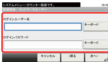
「ログインユーザー名」、「ログインパスワード」の[キーボード]を選択して登録するユーザーの情報を入力して、[OK]を選択してください。
