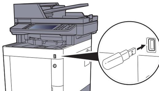
2 挿入したUSBメモリーを認識すると、「外部メモリーを認識しました。ファイルを表示します。よろしいですか？」というメッセージが表示されます。[はい]を選択します。
