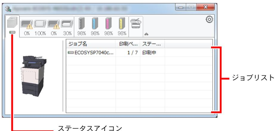
ジョブリストでジョブを選択し、右クリックで表示されるメニューでキャンセルできます。
