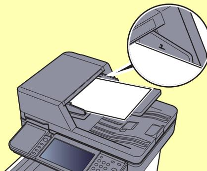
原稿は、原稿上限表示を超えないようにセットしてください。表示を超えて原稿をセットすると、原稿がつまる原因になります。
