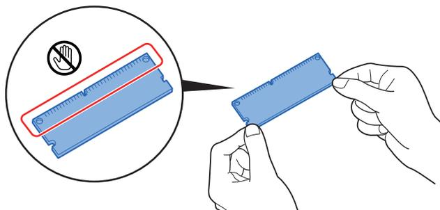
衣類やカーペットなどを通して人体に蓄積される静電気は、半導体チップを数多く搭載したメモリーに悪影響を与えます。静電気による破壊からメモリーを保護するために、装着前に水道の蛇口や金属製のものに触って静電気を除去してください。静電気対策用のリストバンドを手首に巻いて作業することをお勧めします。
