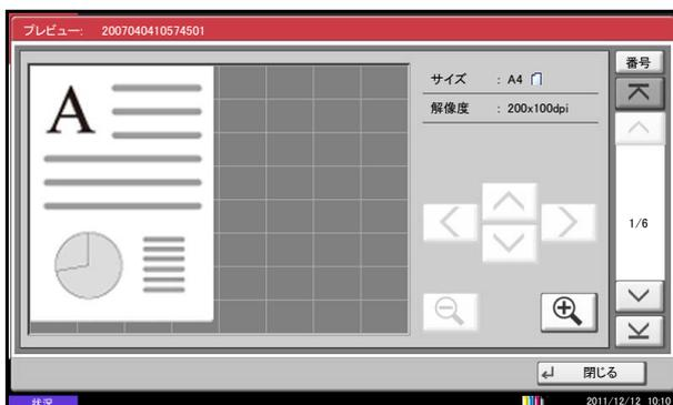
原稿送り装置に複数ページの原稿をセットしている場合は、すべての原稿を読み込み、1枚目のプレビューを表示します。[詳細表示] を押すと、読み込んだすべてのページのプレビュー画面を表示することができます。[∨] を押すと、読み込んだ順にプレビューを表示します。
