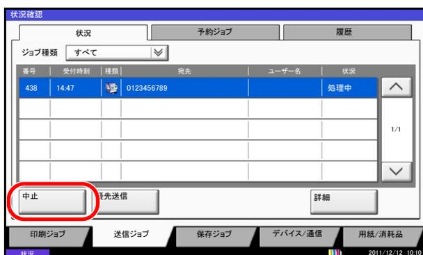
送信を中止するには、送信ジョブ確認画面で、ジョブを選択して[中止]を押してください。
