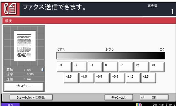
1 [画質] を押し、[濃度] を押してください。[プレビュー] を押すと、送信画像のプレビューを参照できます。詳細は 3-22 ページの送信する原稿のイメージを確認するを参照してください。
