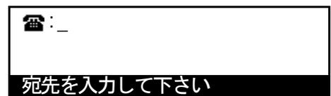
転送先の入力には、短縮ダイヤル、ワンタッチダイヤル、チェーンダイヤルを使用することもできます。また、Fコード通信用に登録したワンタッチダイヤルや短縮ダイヤルを使って相手先を入力した場合は、手順7～10の操作を省略することができます。
