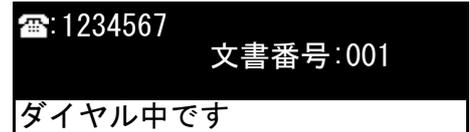
**参考** [画面切替] キーを押している間だけ、通信中の裏動作をメッセージ表示に表示させることができます。このとき [ストップ/クリア] キーを押すと、裏動作の通信をキャンセルすることができます。押しているキーから手を放すと、メッセージ表示は元に戻ります。
