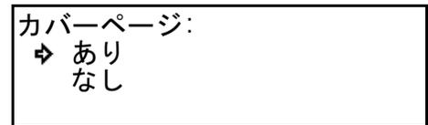
＞両面原稿の先頭に片面印字された送り状などを添付して送信するときは、「あり」を選択してください。機械は、原稿1枚目の片面（裏面）は読み込まずに送信を行います。
