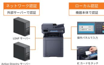
ICカード認証により、ユーザー単位での複合機の利用履歴の確認や、アクセスレベルの設定が可能です。
