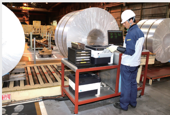
製品に貼り付ける現品票や出荷票のラベルを現場ラインで出力
