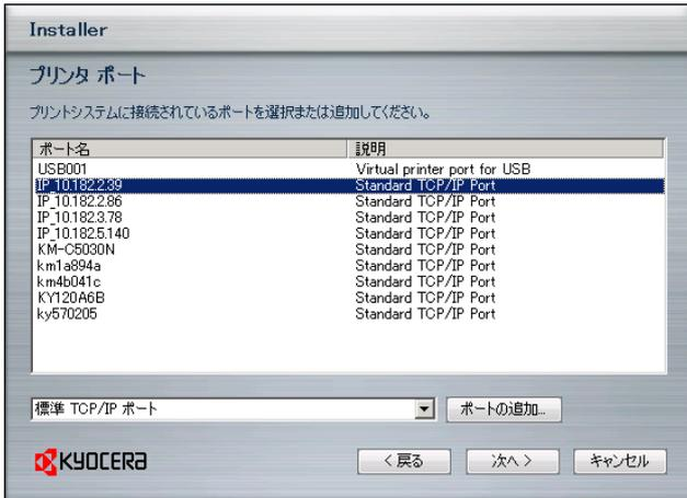
プリンタに接続しているポートをポート一覧から選択し、**次へ**をクリックします。
