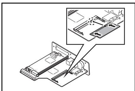
5 オプションの拡張メモリーをパッケージから取り出してください。メモリーの端子部をソケット側にし、切り欠き部分をソケットの突起部分に合わせて、まっすぐ差し込んでください。
