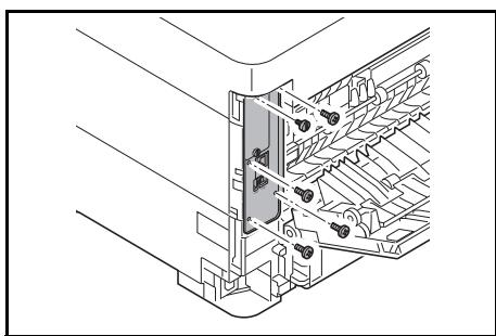
3 メイン基板の背面から取り付けネジ5本を外してください。
