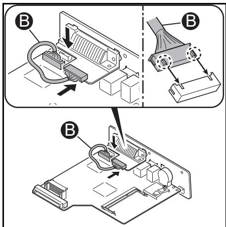
11 オプションの装着後、メイン基板を取り外したときと逆の手順でプリンターに装着し、ネジで固定してください。
