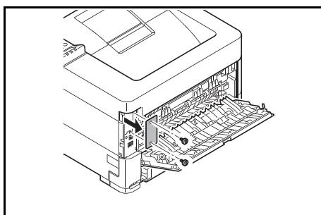
3 取り付けネジ2本を外して、プレートを取り外してください。
