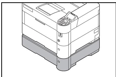
オプションのペーパーフィーダー PF-4100 のカセットには約 500 枚の用紙が収納できます。プリンターの下に 4 台まで重ねて装着できるので、プリンターのカセットと合わせると最大 2500 枚を連続給紙できます。
